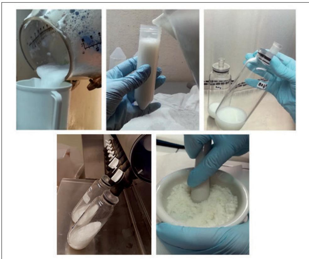
Fig. 4 - Passaggi principali utilizzati nel processo di liofilizzazione.
